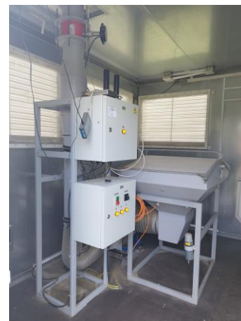
Фото 3 – Воздухо-фильтрующая установка М-39 для отбора проб аэрозолей
