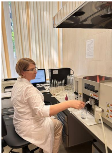
Фото 2 – Определение тяжелых металлов на спектрофотометре AA-6200
