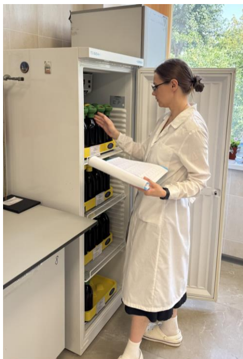
Фото 2 – Смирнова Е.А. - ведущий гидрохимик ОМПВ, определение биохимического потребления кислорода в пробах воды манометрическим методом
