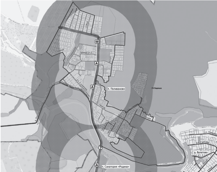
Рис. 3.5.2.5.1.1 Схема сети маршрутов регулярных пассажирских перевозок с радиусами нормативной обеспеченности пешеходного подхода до остановки общественного транспорта 500 м и 800 м.
