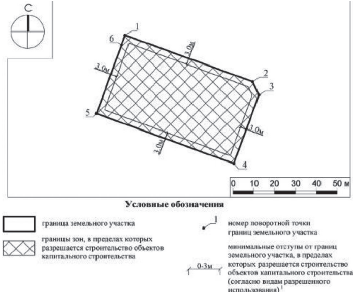
Рисунок 2 – Чертеж градостроительного плана земельного участка
