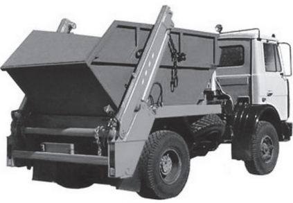
Рис. 4.16. Бункеровоз МКС-3501 на шасси МАЗ-5551А2
