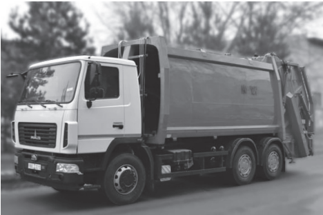
Рис. 4.15. Мусоровоз с задней загрузкой КО-427-90 на базе шасси МАЗ-6312С3
