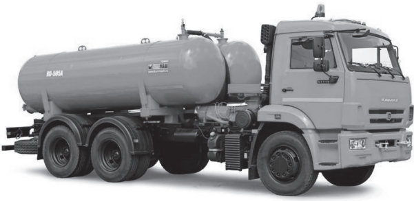
Рис. 5.1. Вакуумная машина КО-505А на шасси КамАЗ-65115-71
