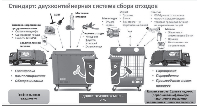
Рис. 4.2. Стандарт: двухконтейнерная система сбора отходов
