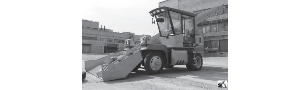
Рис. 6.20. Лаповый снегопогрузчик КО-206. Время, затрачиваемое 1 самосвалом на 1 рейс при бесперебойной погрузке: T1cm1рейс = t3 + tP + t0 + tE
