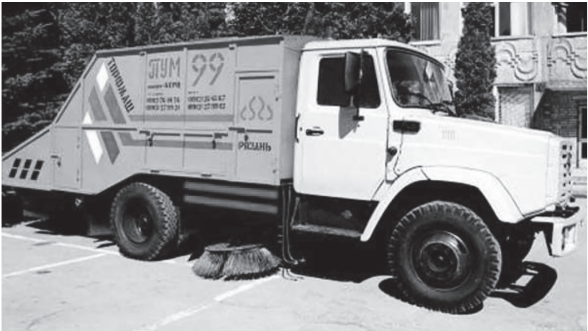
Рис. 6.18. Вакуумная подметально-уборочная машина ПУМ-99 на базе шасси «Зил». Необходимое количество подметально-уборочных машин определяется по формуле:
