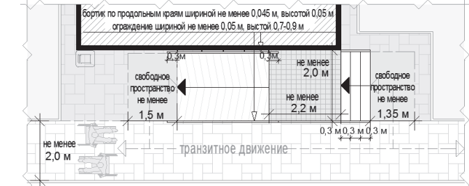
схемы основных параметров входной группы для покупателей при высоте входной площадки от уровня земли от 0,45 м: при ширине тротуара не менее 2,0 м:
