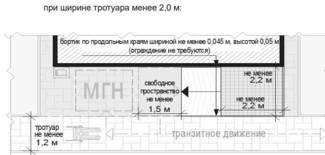
Рис. «Основные параметры места размещения нестационарного торгового объекта для павильонов» схемы места размещения нестационарного торгового объекта при островном размещении павильона с тупиковым подходом:
