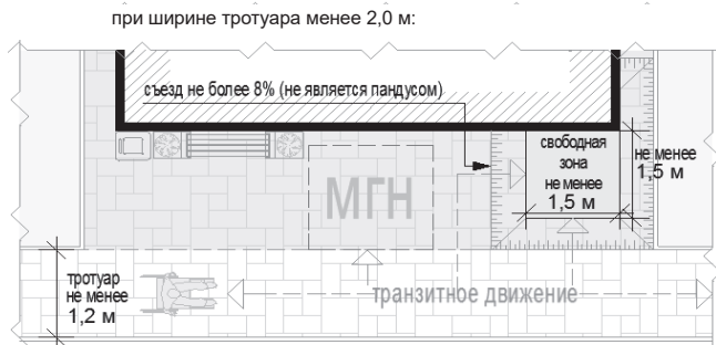
схемы основных параметров входной группы для покупателей при высоте входной площадки от уровня земли до 0,45 м:
