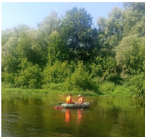
Фото 8 – Измерение расхода воды на р. Москва - ГП Звенигород
