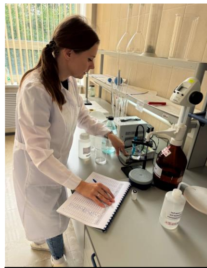
Фото 3 - Градуировка ионметрического преобразователя И-500
