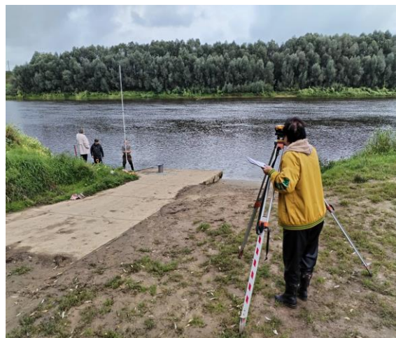
Фото 9 – Нивелировка постовых устройств при проведении инспекции р. Клязьма – ГП Галицы
