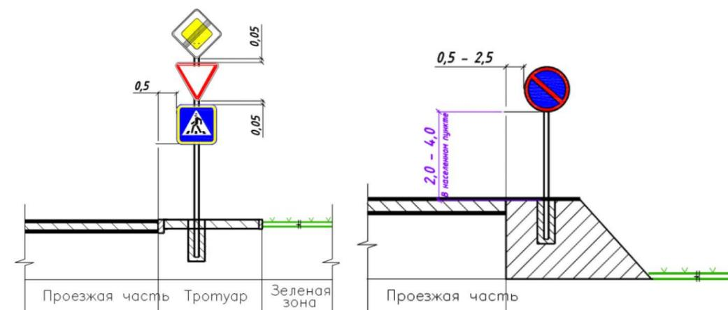
Рисунок 1 – Способы установки дорожных знаков
