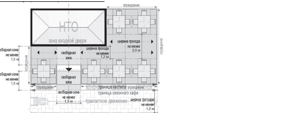
площадка сезонного (летнего) кафе 26-50 мест с павильоном или блоком модулей палаток и технологическим настилом, однорядное размещение:
