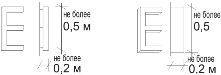
Рис. «Основные параметры средств размещения информации» элементы вывесок киосков и павильонов располагаются в виде отдельных элементов без фона:
