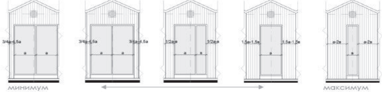
схема допустимого изменения баланса остекления и простенков:
