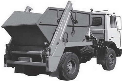
Рисунок 17. Бункеровоз МКС-3501 на шасси МА3-5551А2
