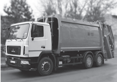
Рисунок 16. Мусоровоз с боковой загрузкой КО-427-90 на базе шасси МАЗ-6312С3
